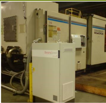
Wisconsin (EE. UU.) SyncroSpeed 135 HP, sistema de dos motores instalado en una Cincinnati de 725 t
