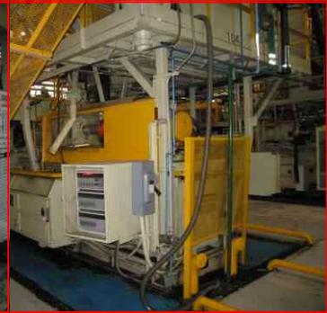
máquina inyectora de 1500t
