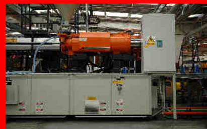
Armadio elettrico SyncroSpeed singolo 90kW su Engel ES4550/600
